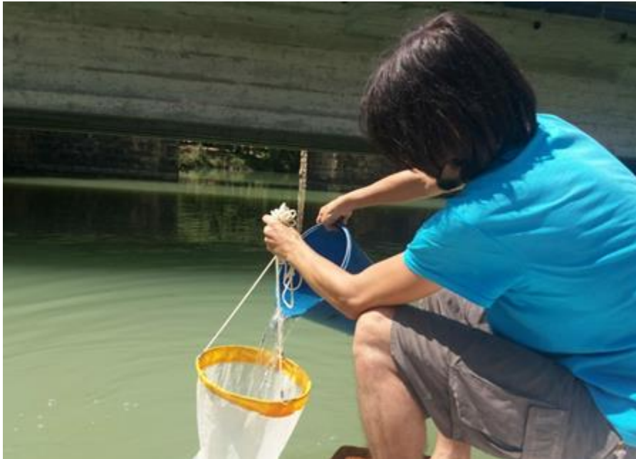
Imagen 1: Toma de muestras cuantitativa de zooplancton mediante red de plancton.
